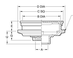
Fig. 6010C . . . CAULK OUTLET Fig. 6010T . . . THREADED OUTLET Fig. 6020C . . . CAULK OUTLET
